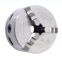
研削作業の際によく使用するもので、このチャックは 0.005mmの同心精度が可能です。また、0.013mm 以内の繰り返し精度が得られます。通常のチャックとしても使用可能です。アダプタープレートは標準品に手を加えることによってご要望により製作いたします。
