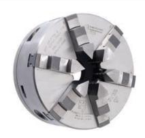
6 つ爪のチャックは、肉厚の薄いワークの歪みを減らすため、または把握力をもっと均一に拡散させるために使用します。これで研削作業でより良い仕上がりを得ることが出来ます。研削作業の際によく使用するもので、このチャックは 0.005mmの同心精度が可能です。また、0.013mm 以内の繰り返し精度が得られます。通常のチャックとしても使用可能です。アダプタープレートは標準品に手を加えることによってご要望により製作いたします。
